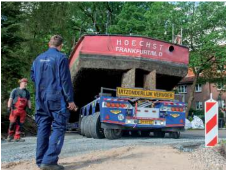
Positionierung des Tiefladers zum Abladen, Foto: D. Mamerò
