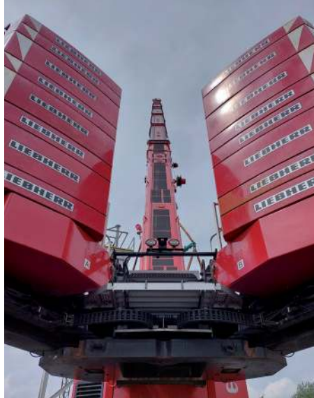
450-Tonnen-Autokran mit 100 Tonnen Gegengewicht, Foto: Peter Lienau
