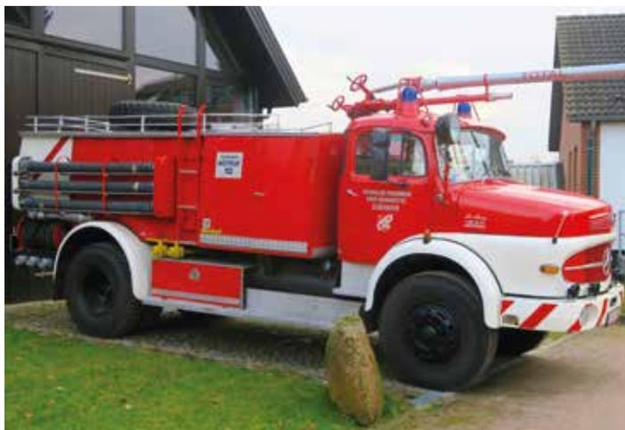
Schaumtankfahrzeug/Zumischerfahrzeug ZLF 4500, Foto: FMSH
